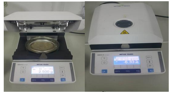
ภาพที่ 2 แสดงค่าการหาค่าความชื้นของผงยาสมุนไพรในแต่ละสูตรตำรับด้วยเครื่อง Moisture Analyzer รุ่น HB43-S วิเคราะห์ความชื้นอุณหภูมิ 105 °C
